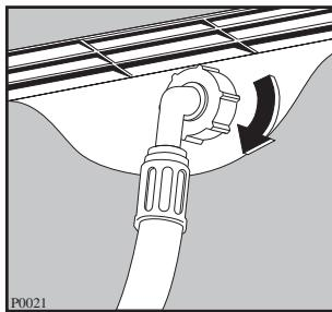
Подключите наливной шланг к водопроводному крану с резьбой 3/4".
